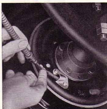
Fig. 27. Lubricating the handbrake cable
